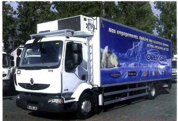
Orlygel dispose d'un véhicule 16 t Euro V équipé d'un groupe frigorifique Frigoblock FK25L.
